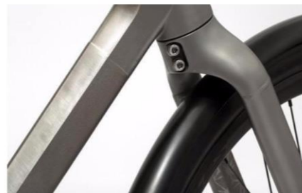
3D打印的金属钛自行车车架
