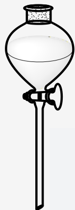
球形分液漏斗 (用作加液器)
